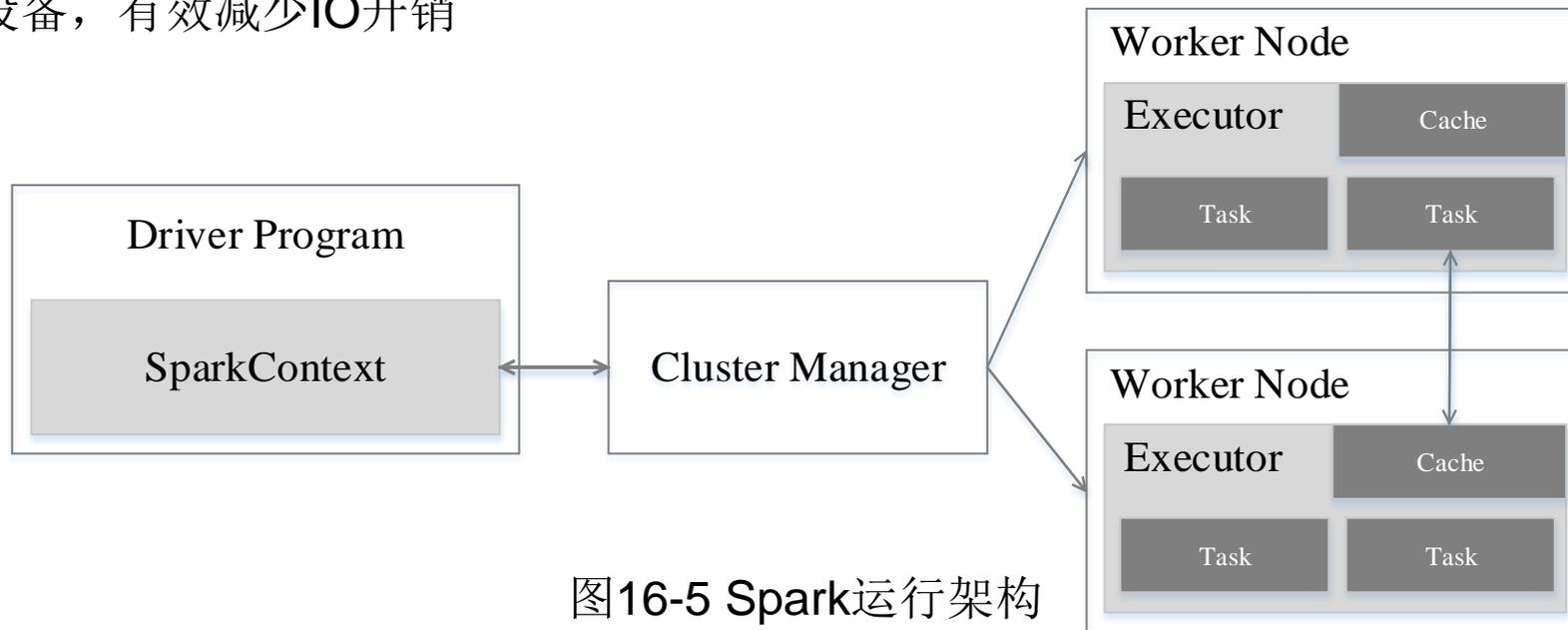
图16-5 Spark运行架构
