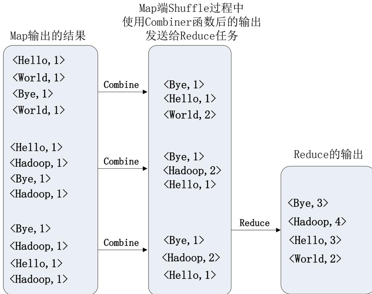
图7-9 用户有定义Combiner时的Reduce过程示意图
