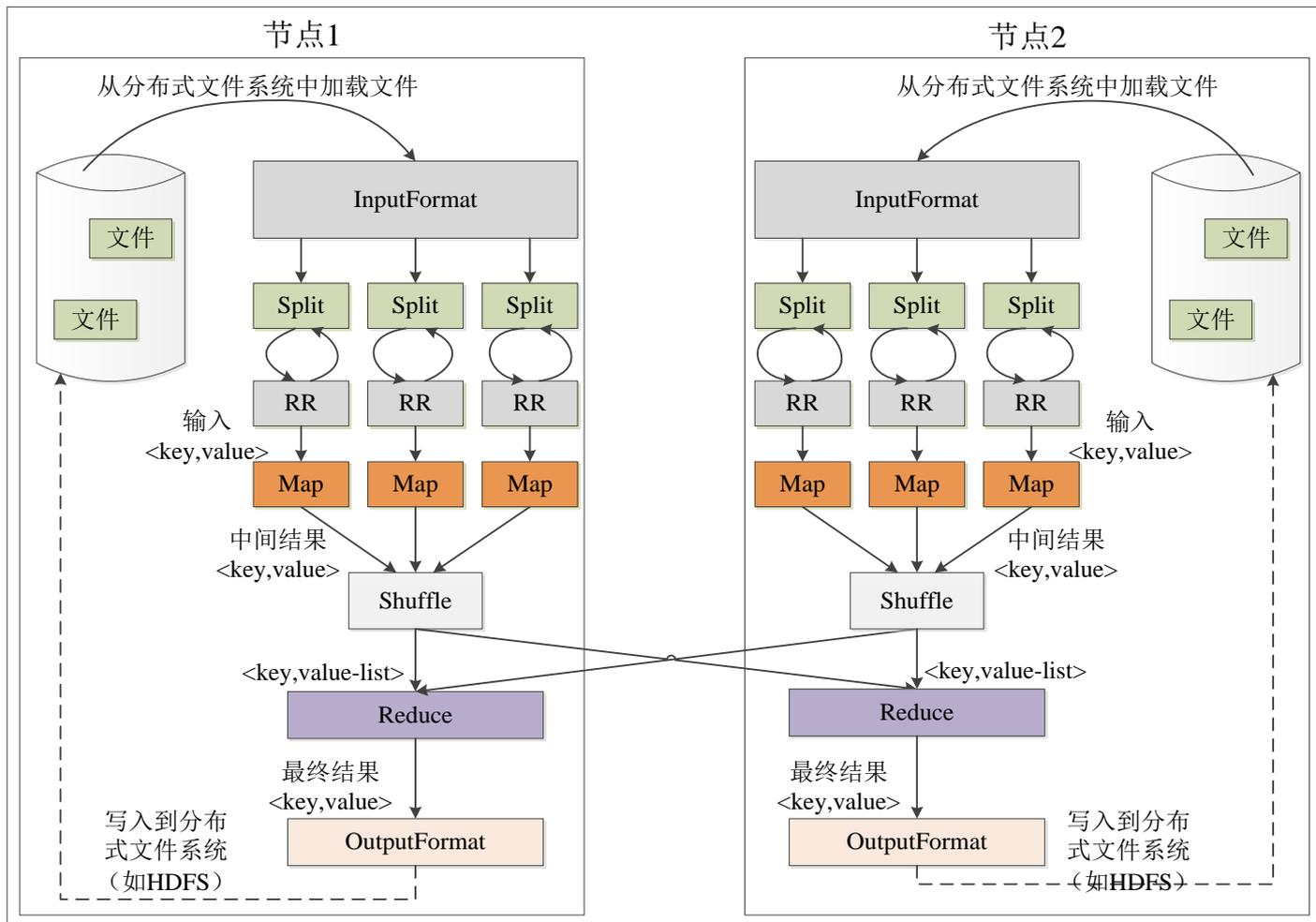
图7-2 MapReduce工作流程中的各个执行阶段
