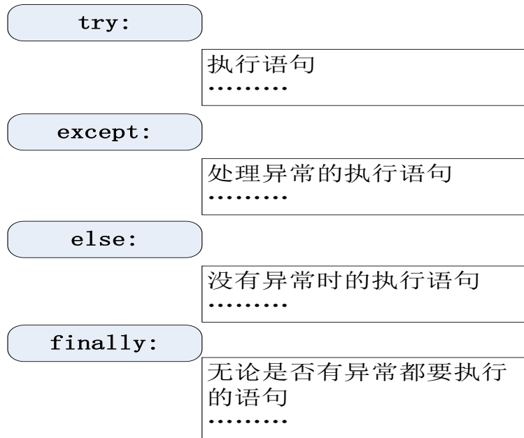
图9-5 异常处理结构（try/except...else...finally...）
