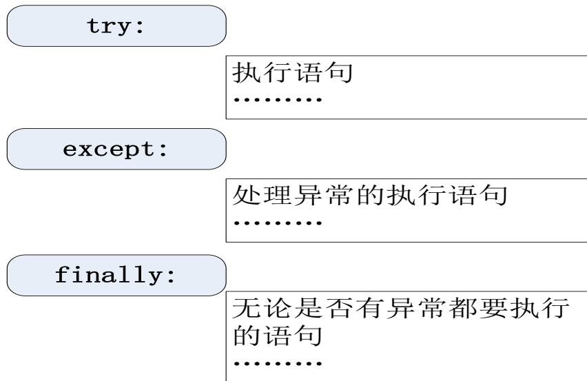
图9-4 异常处理结构（try/except...finally...）
