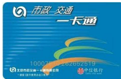
图1-11 采用RFID芯片的公交卡
